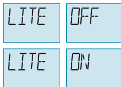
Figure 2-30 Réglages du rétroéclairage LITE OFF (éclairage éteint) et LITE ON (éclairage allumé)
